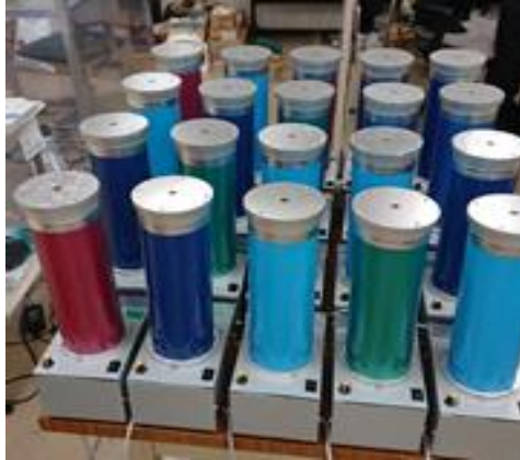
図 4 家庭用除菌空気清浄機 RA-02 試作機写真 (高さ 400 mm、径 90 mm φ、UV-C10W1 本)
