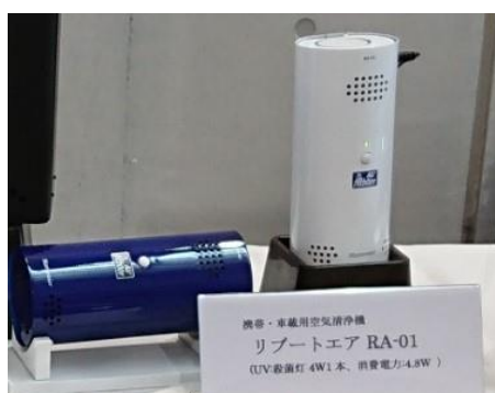
図 3 乗用車用除菌空気清浄機 RA-01(高さ 180 mm、径 70 mm φ,UV-C4W1 本)
